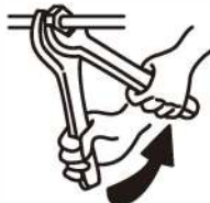
Imagen 4.2 Ajuste de la tuerca cónica
